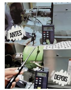
A diferença é visível: o isolamento térmico reduz a perda de calor. Menos calor desperdiçado, mais economia.
